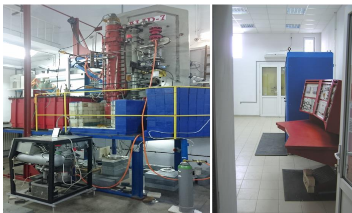
Figura 1. Acceleratorul liniar de electroni ALID 7: Instalatia de iradiere și pupitrul de comandă
